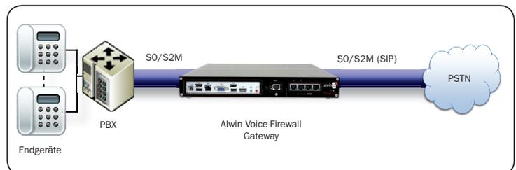
Abb. 6: Alwin Voice-Firewall zwischen TK-System und Amt platziert
